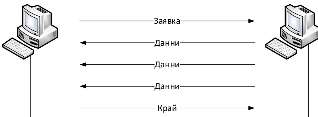
Фиг. 9.13. Примерен обмен на данни при протокол UDP.
