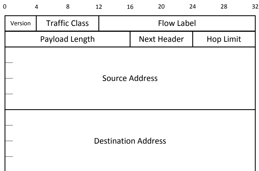
Фиг. 6.7. Заглавна част на IPv6.
