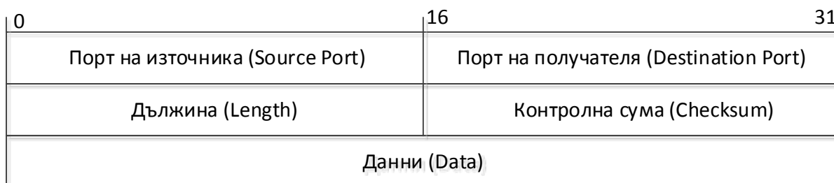
Фиг. 9.12. Заглавна част на протокол UDP.
