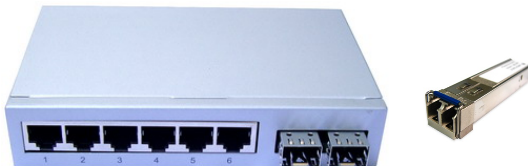
Фиг. 3.13. Комутатор с оптични портове и SFP модул.
